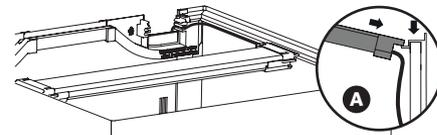
(FR) Placer à l'extrémité qui contient le câble. (Schéma A)
