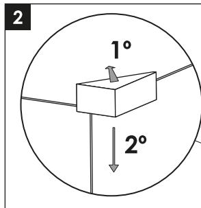
**FR**•Attention : nettoyer le verre à l'aide d'alcool avant de coller les appuis. Coller les appuis au réservoir, conformément à l'image A, selon l'ordre suivant : 1° Appuyer les parois de l'appui sur le réservoir. 2° Presser la base de l'appui contre le fond de la cuve.
