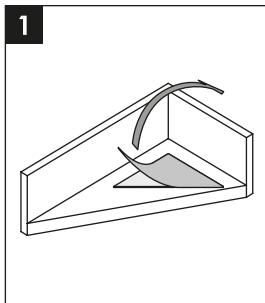
**FR**•Retirer la pellicule de protection de la bande autocollante de l'appui.
