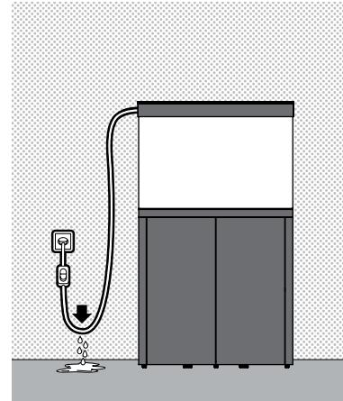
**(FR)** L'aquarium nécessite une prise de courant. Attention aux éclaboussures. Ne placez pas l'aquarium au-dessus d'un appareil électrique. Faire un "col de cygne" pour éviter que l'eau entre en contact avec la prise de courant.
