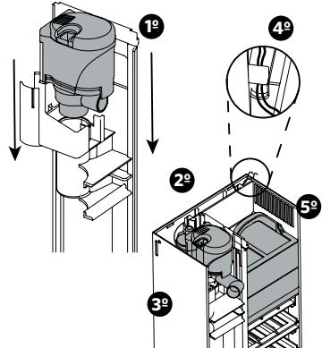
**(FR)** 1<sup>e</sup> Placez la pompe dans le séparateur du filtre de manière à ce qu'elle soit bien serrée 2<sup>e</sup> Placez le séparateur du filtre 3<sup>e</sup> Placez le coude de la pompe et ajustez comme indiqué sur l'image 4<sup>e</sup> Ajustez les câbles de la pompe et du thermoplongeur 5<sup>e</sup> Ajoutez le support de consommables.
