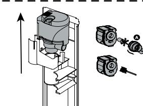
**(PT)** 1º Retirar a curva da bomba 2º Extrair os cabos da bomba e do aquecedor 3º Remover o separador do filtro.
