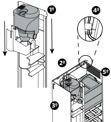
**(PT)** 1º Colocar a bomba no separador do filtro 2º Colocar o separador do filtro 3º Colocar e ajustar todos os cabos 5º Inserir o suporte de consumíveis.
