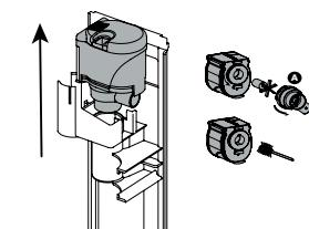
**(FR)** 1<sup>e</sup> Retirez le coude de la pompe 2<sup>e</sup> Enlevez les câbles de la pompe et du thermoplongeur 3<sup>e</sup> Retirez le séparateur du filtre.
