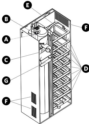
**(FR)** Pour un parfait fonctionnement du filtre Ciano® CFBIO XL il est nécessaire de placer tous les éléments de la façon suivante: **A**) Pompe; **B**) Thermoplongeur; **C**) Courbe de sortie d'eau; **D**) Masses filtrantes; **E**) Support de consommables; **F**) Thermomètre (option).
