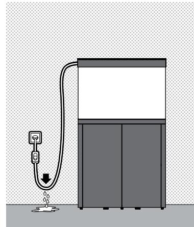
**(PT)** O Emotions® tem de ser ligado à corrente. Atenção aos salpicos. Não coloque o Emotions® em cima de um aparelho elétrico. Deverá efetuar uma "curva de gotejo" para evitar que a água entre em contacto com a corrente elétrica.
