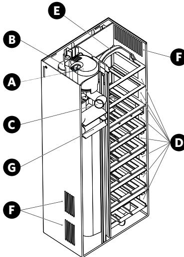
**(PT)** Para um perfeito funcionamento do filtro Ciano® CFBIO XL é necessário que os componentes sejam colocados segundo a imagem: **A**) Bomba; **B**) Aquecedor; **C**) Curva de saída de água; **D**) Massas filtrantes; **E**) Suporte de consumíveis; **F**) Entradas de água; **G**) Termômetro (opcional).
